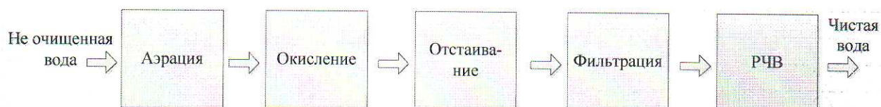
Рис. 3.1. Блок-схема процесса очистки воды
